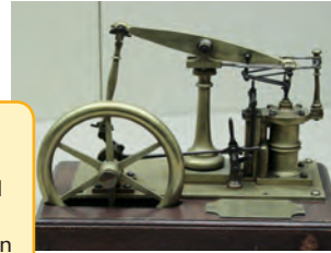
Modell einer Dampfmaschine mit Wattschem Parallelogramm von Samuel Pemberton, erbaut zwischen 1880-1890.
